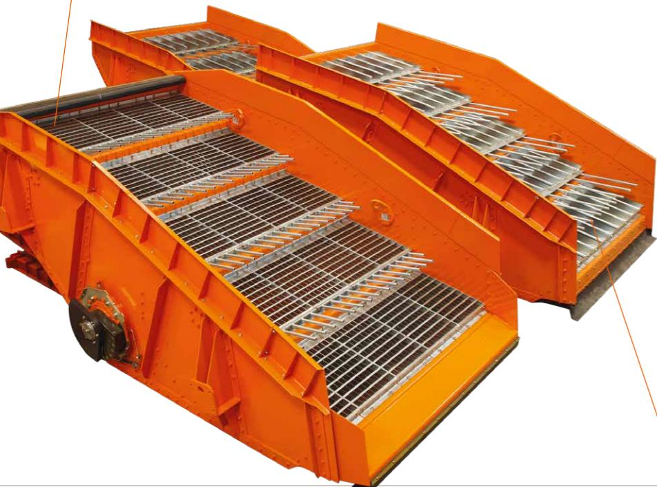
Zusätzlich installierte **Roststangen** sorgen für eine weitgehende Materialauflockerung und verhindern das Zudecken der offenen Siebflächen durch großflächige Materialien.
