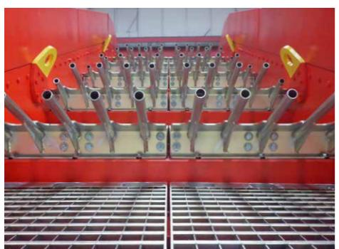
Optimierte Siebbelagsausführung: Die höchstmögliche offene Siebfläche, die spezielle Geometrie der Öffnung und die Kombination mit installierten Roststangen...
