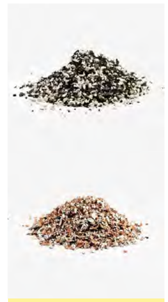
Aufbereiteter Kabelschrott Processed cable scrap
