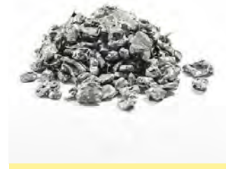
Aufbereiteter WEEE-Schrott Processed WEEE Scrap
