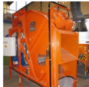
Sondermodell mit Luftunterstützung (Type UHL) Special model with air support (type UHL)
