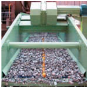
Siebung von Zuschlagstoffen Screening of additives
