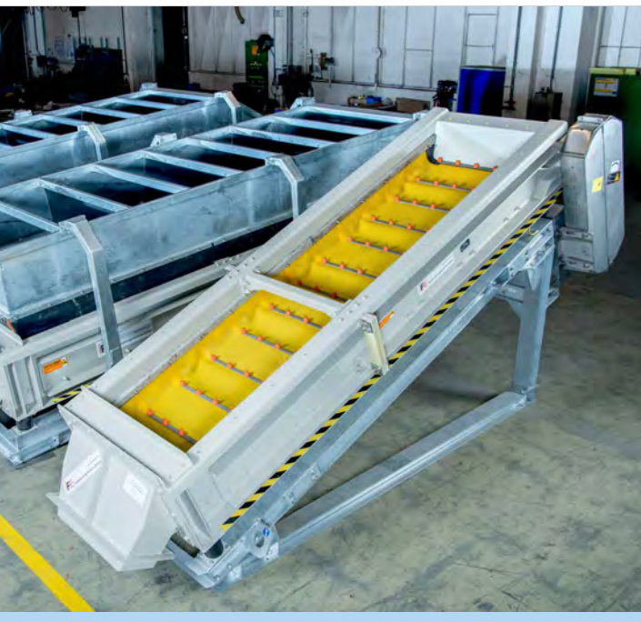
Effiziente Siebung durch einzigartige Drei-Phasen-Schwingung Efficient screening through unique Three-phase-oscillation
