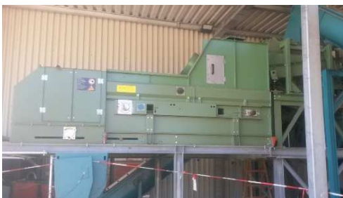
Abb. 5: Nichteisenscheider zur Abtrennung von Alu, Messing, andere NE-Teile und Rest FE-Teilen aus der Altholzfraktion
