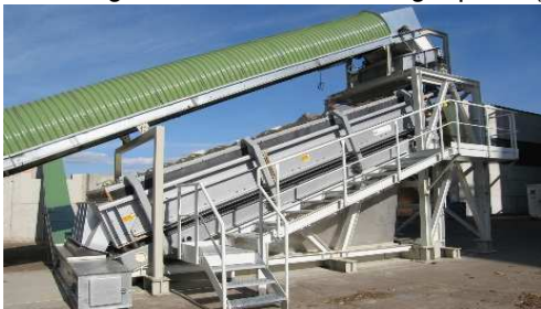
Abb. 2: Spannwellensieb zu Kontrollsiebung von Sägespänen mit Aufgaberinne zur Materialverteilung
