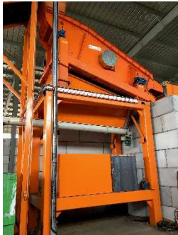
Abb. 4: Doppeldeck-Müllsieb zur Fraktionierung von zerkleinerten Bahnschwellen
