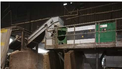
Abb.8: Permanentmagnetscheider, Aufgaberinne und zentraler Wirbelstromscheider zur Reinigung von Altholz
