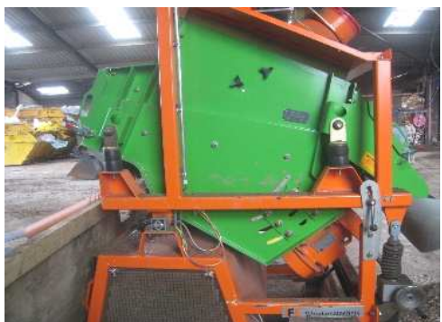
Abb. 3: Feinsortiersystem zur Erzeugung verschiedener Fraktionen aus gemischten Holzabfällen
