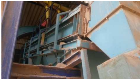
Abb. 1: Spannwellensieb zur Absiebung von Holzstaub aus granuliertem Altholz
